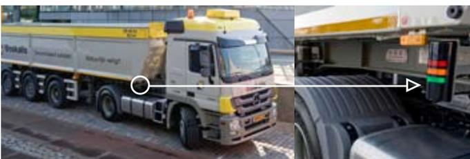
**Boskalis BV a développé un nouveau système pour éviter que les camions ne soient surchargés. Trois lumières sont installées sur le côté du tombereau et connectées au dispositif de pesage du camion. Au moment où le chargement commence, les lumières vertes s'allument. Lorsque le chargeur s'approche du poids critique, les lumières tournent à l'orange. C'est le moment de stopper le chargement. Et si les lumières tournent au rouge, alors vous savez que le tombereau est surchargé !**
