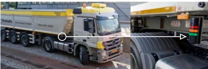
Boskalis BV ha desarrollado un nuevo sistema para evitar la sobrecarga de los camiones. Se han montado tres luces en un lateral del camión volquete, conectadas a su instalación de pesaje. En cuanto se empieza a cargar, las luces verdes se encienden. Cuando la carga alcanza un punto crítico, las luces se iluminan en naranja: es el momento de parar. Si se encienden en rojo, ¡el camión está sobrecargado!
