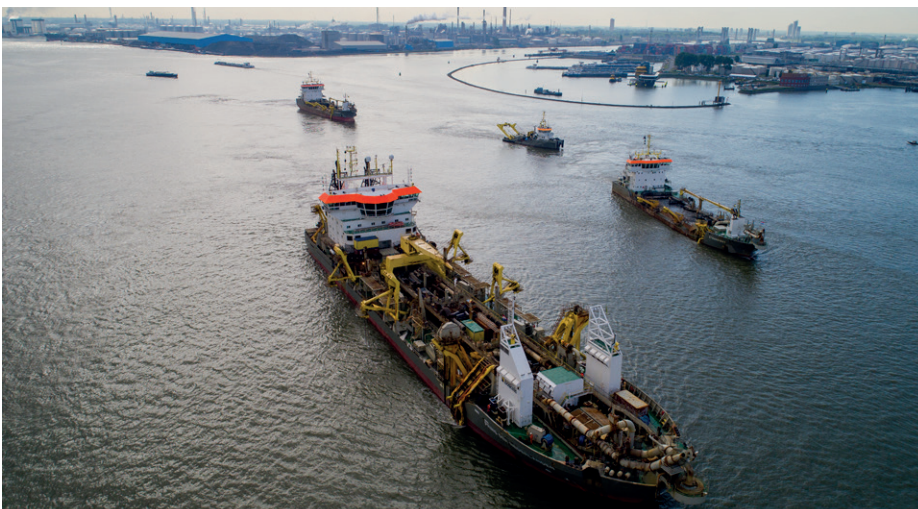
| Imuruoppaajat Prins der Nederlanden, Strandway ja Causeway töissä Nieuwe Waterweg & Botlek -syvennyshankkeessa
