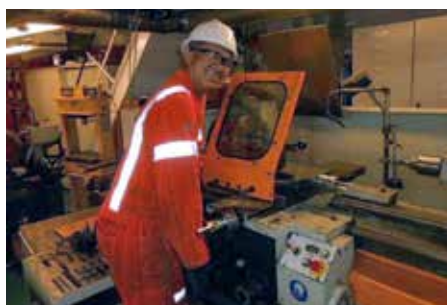
| Torno con dispositivos de seguridad. Aun así, se tiene que llevar el PPE (Personal Protection Equipment) adecuado.
