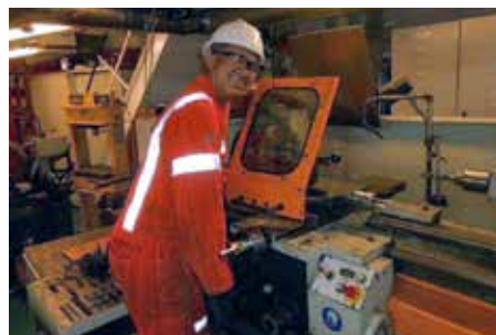
| Tour avec tous les dispositifs de sécurité. L'EPI approprié (Equipment de Protection Individuelle) doit encore être utilisé.
