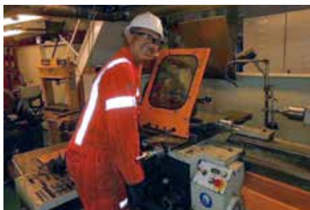
| Draaibank met alle veiligheidsvoorzieningen. Alsnog moet de juiste PPE gebruikt worden.
