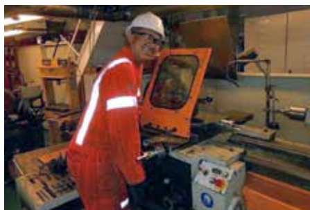
| Drehbank mit allen Sicherheitseinrichtungen. Dennoch muss die korrekte PSA getragen werden.
